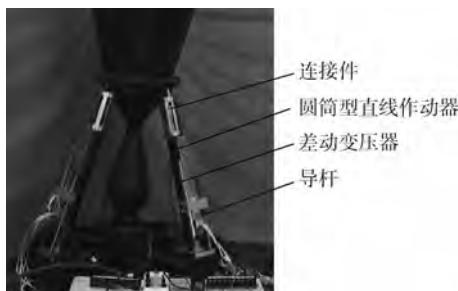
图 7 无槽圆筒型直线作动器样机
