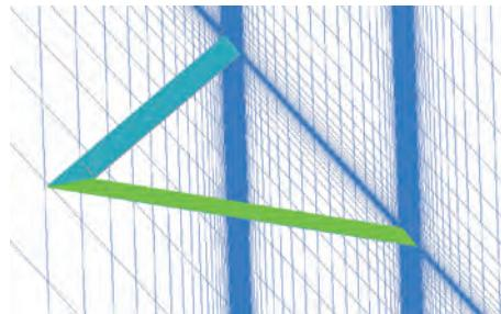
图 4 Model 1 网格示意图
