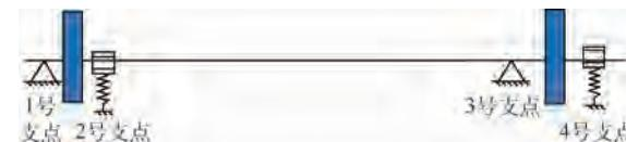
图 6 采用支承松动设计的多支点柔性转子力学模型
