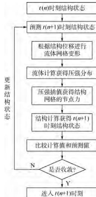
图1 CFD/CSD预估-校正迭代方法流程
