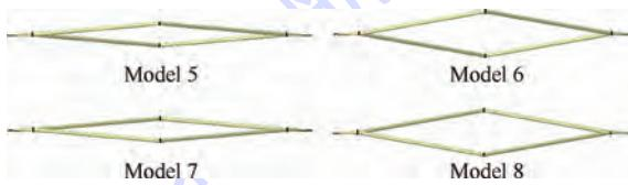
图 17 改变翼夹角的菱形连翼无人机布局
