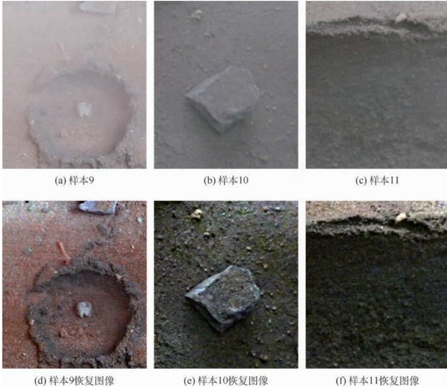
图 13 不同场景下受沙尘影响图像及对应恢复图像
