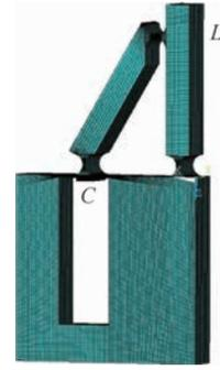
图11 微动夹持器有限元网格划分模型
