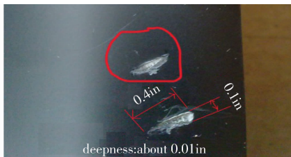
图 2 桨叶破损位置示意图
