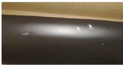
图 1 桨叶破损原始照片
