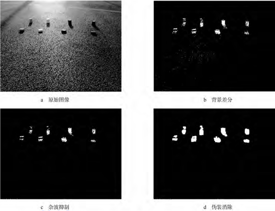
图 3 阳光下的 FOD 目标检测结果 Fig. 3 Detection results of FOD targets in the sunshine
