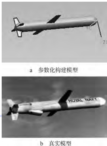
图 6 类 BGM-109 模型与真实模型对比图 Fig. 6 Quasi/real BGM-109 model geometry differences
