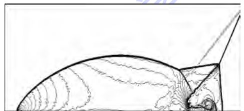
图 5 HCW-U-R, DMR 问题, 密度云图, 50 条等值线 Fig. 5 HCW-U-R, DMR problem, density contour, 50 levels
