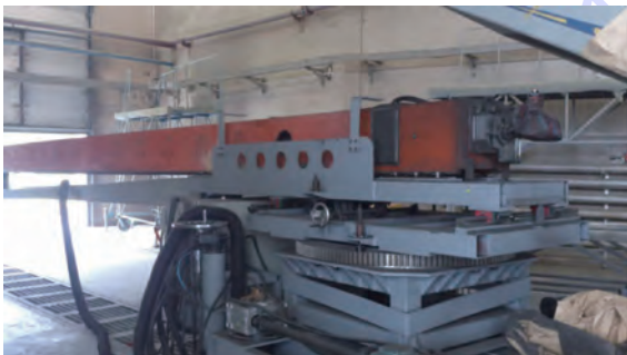
图10 调姿后的喷涂机器人
