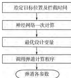
图3 应用神经网络的弹道设计流程图 Fig. 3 Trajectory design flow chart using neural network
