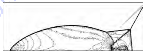
图 6 HCW-U-Z, DMR 问题, 密度云图, 50 条等值线 Fig. 6 HCW-U-Z, DMR problem, density contour, 50 levels
