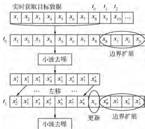
图3 滑动数据窗原理 Fig. 3 Sliding data window
