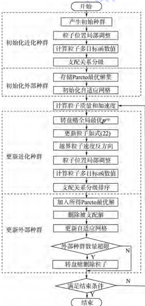
图 2 MODPSOGSA 算法流程图 Fig. 2 Procedure of MOPSOGSA
