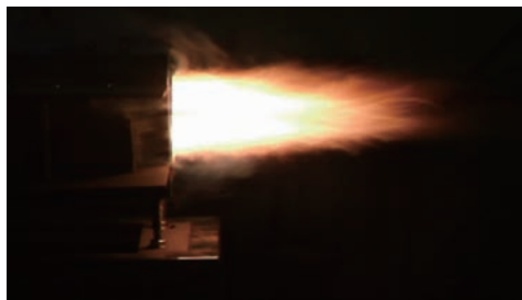
图6 出口温度 2400 K 无种子时尾流形状
