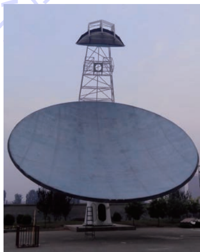
图10 15 m 直径的整体结构碳纤维/环氧树脂材料天线反射器
