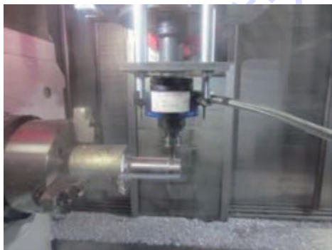
图 10 切削力测试实验设置
