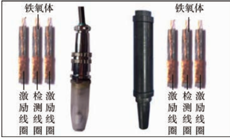
图4 差动式探头及内部线圈结构
