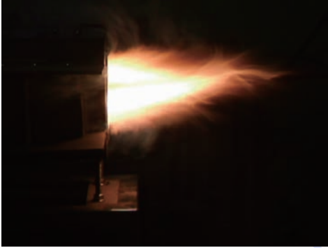
图 9 出口温度 2000 K 电离种子含量 2.5% 磁场反向时尾流形状
