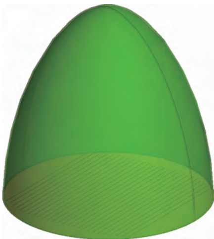
图5 1604个单元的带罩天线阵列模型结构
