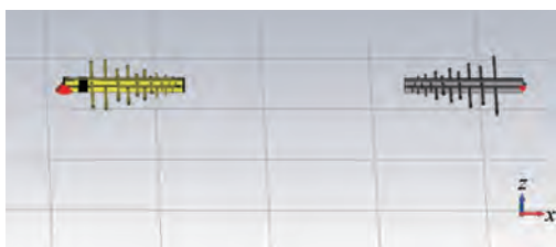
图7 自由空间天线系数测试仿真模型
