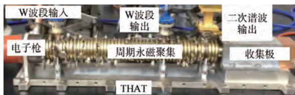
图 10 太赫兹 FWG 结构的 THAT 照片 Fig. 10 Photo of THAT using FWG structure
