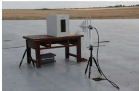
(b) 开阔试验场辐射发射测试布置实物图
