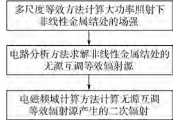
图 4 场路结合方法分析无源互调的流程图
