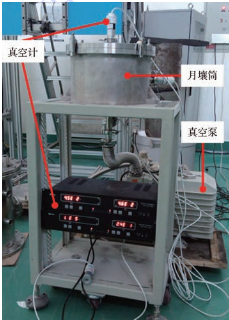
图 1 真空环境模拟器 Fig.1 Vacuum environment simulator
