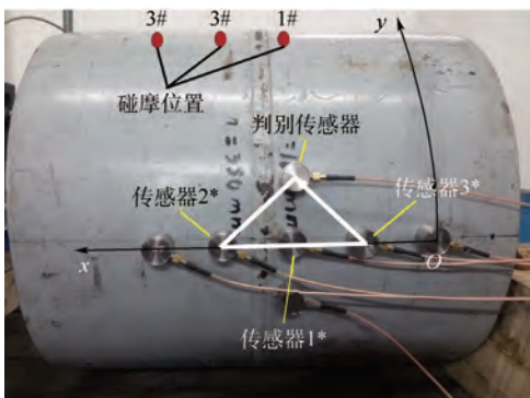
图 11 改进后的阵列布置及坐标系位置
