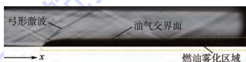
图 8 纹影图和数据采集方式
