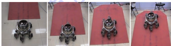
图 31 机器人轮行爬坡试验
