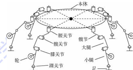
图 1 机器人机构设计简图
