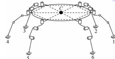
图 5 机器人六腿支撑等效机构
