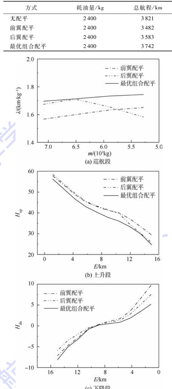
图6 3种配平方式下的性能指标
