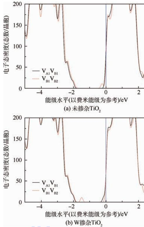
图4 W掺杂前后不同构型的氧空位对的电子态密度
