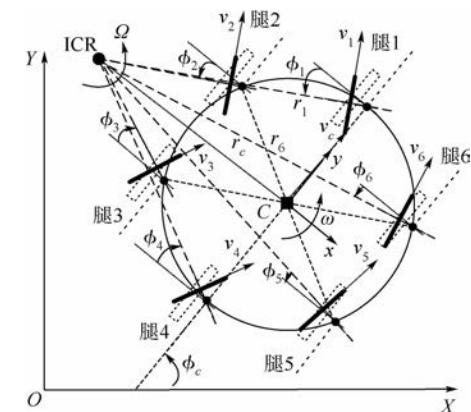
图 22 机器人 6 轮转向机构简图 I
