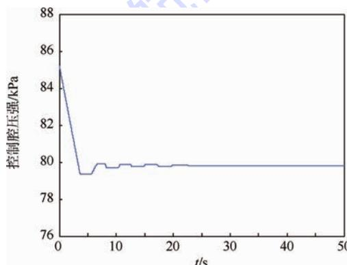
图 11  $k_b = 4.19 \text{ N/cm}$  时排气活门控制腔内压力的全物理仿真结果
