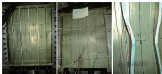
图12 加筋板典型压缩破坏模式
