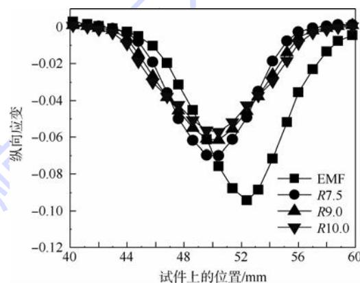
图 16 试件 V 形圆角内侧纵向压应变
