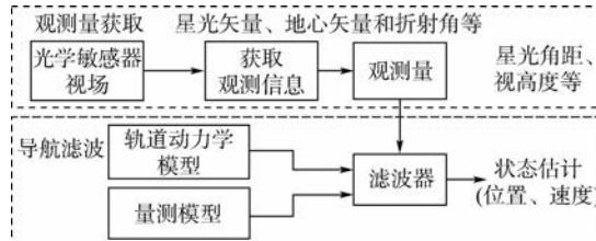
图 1 天文导航系统工作流程
