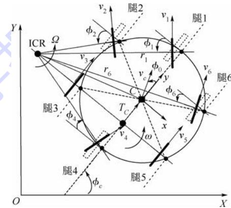
图23 机器人6轮转向机构简图Ⅱ
