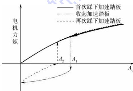
图5 电机力矩与加速踏板位移关系
