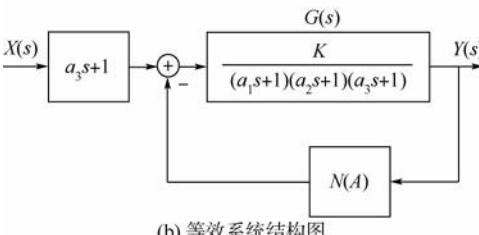
图 8 座舱压力调节系统框图
