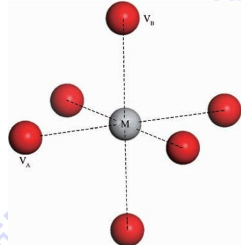
图 1 金红石 TiO<sub>2</sub> 结构中 TiO<sub>6</sub> 八面体构型
