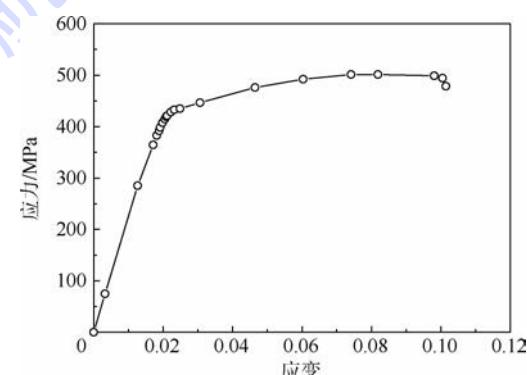
图 4 平板拉伸工程应力-应变曲线
