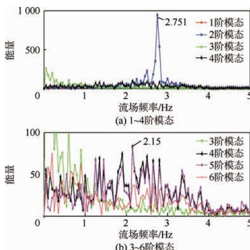
图8 柔性隔板工况1~6阶模态的流场频率
