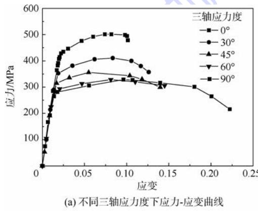
(a) 不同三轴应力度下应力-应变曲线
