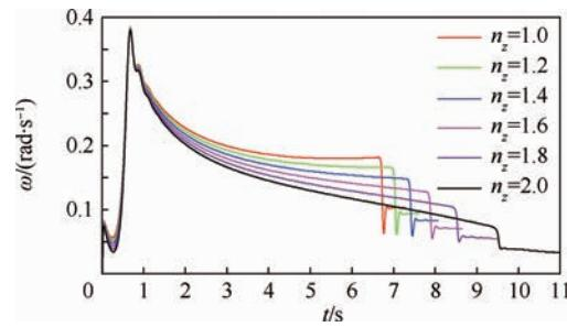
图 4 常规设计不同过载工况下支柱绕收放转轴角速度
