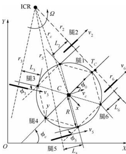
图 25 机器人 4 轮转向机构简图
