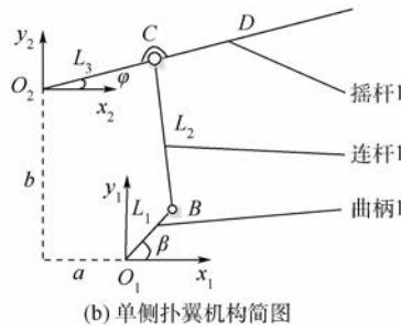
图3 扑翼机构结构图
