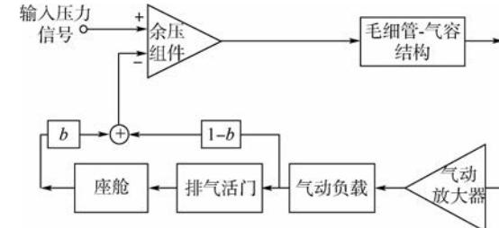
图 2 余压飞行段系统结构图
