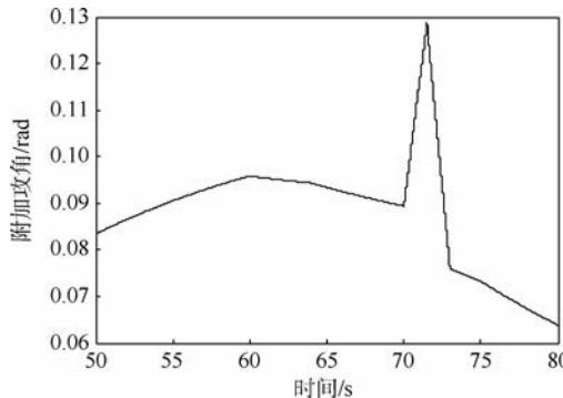
图 5 在高空风作用下的附加攻角
