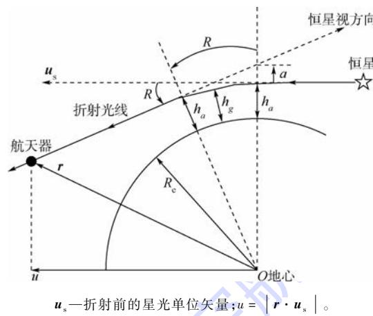
图 7 星光折射敏感地平量测模型
