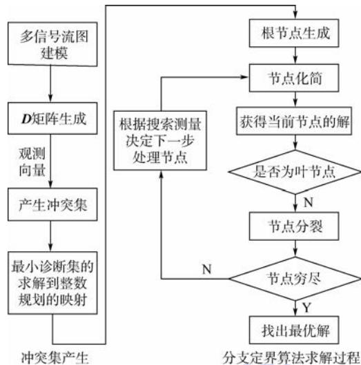
图 2 基于分支定界算法的故障诊断流程
