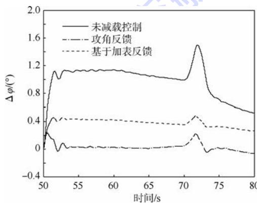
图 6 在高空风作用下的俯仰角偏差曲线
