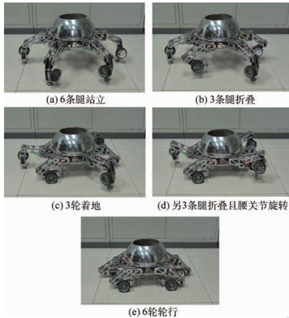
图 29 机器人运动模式切换试验
