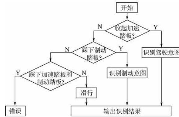
图6 回馈制动控制流程
