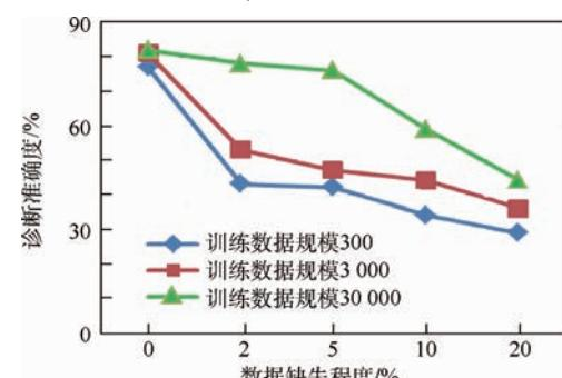
图3 缺失训练数据对诊断准确度的影响
