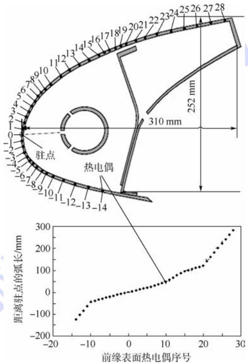
图 2 防冰腔结构及温度测点布置
