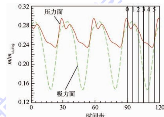
图 12 冷却孔质量流量随时间步长的变化
