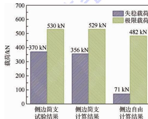
图14 铝合金加筋板试验和计算结果
