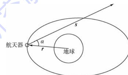
图6 直接敏感地平量测模型
