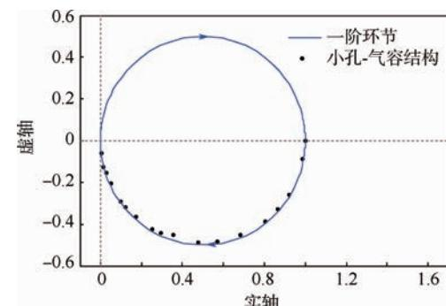
图 7 小孔-气容结构充放气的幅相特性与一阶环节的幅相特性
