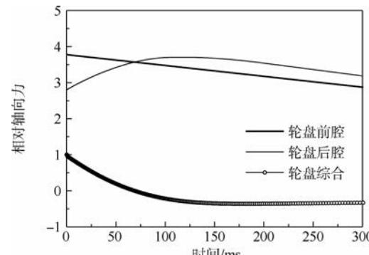
图 12 轴断裂失效后的相对轴向力瞬变过程
