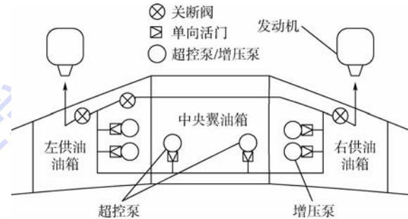
图 3 某型飞机燃油系统原理图
