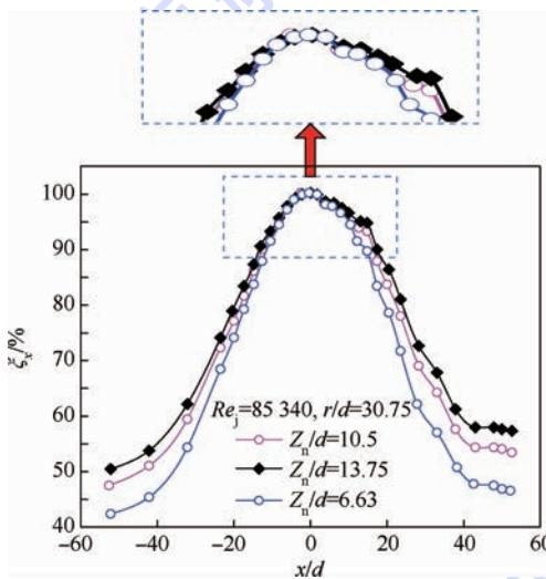
图5 相对管壁距 $Z_n/d$ 对 $\xi_x$ 的影响
