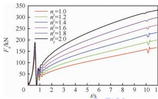
图 11 变速设计不同过载工况下作动筒推力
