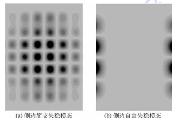
图 11 加筋板失稳模态计算结果
