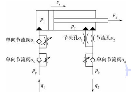
$s_a$ —收放作动筒位移; $F_a$ —收放作动筒输出推力;
