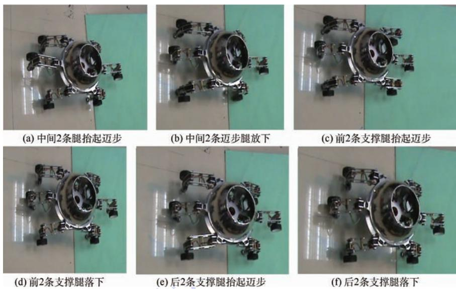
图 26 机器人步行爬坡试验
