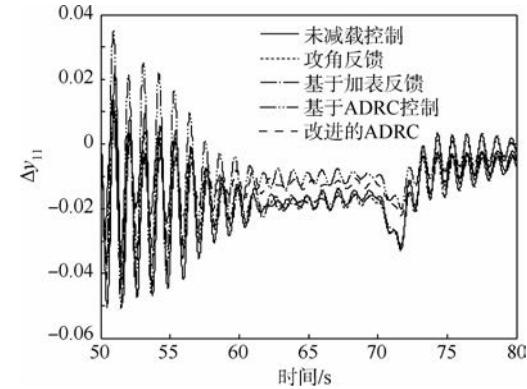
图 12 1号贮箱一阶晃动随时间的变化
