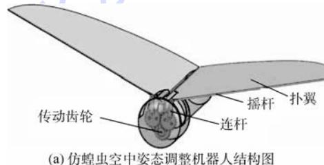
(a) 仿蝗虫空中姿态调整机器人结构图
