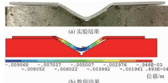
图 11 电磁 V 弯试件纵向轮廓
