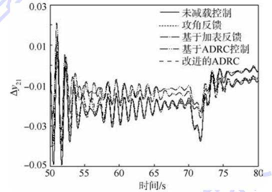
图 13 2号贮箱一阶晃动随时间的变化
