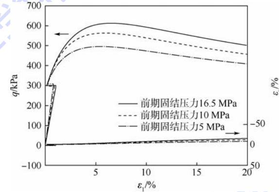
图4 加载—湿化—再加载路径下的应力应变曲线1
