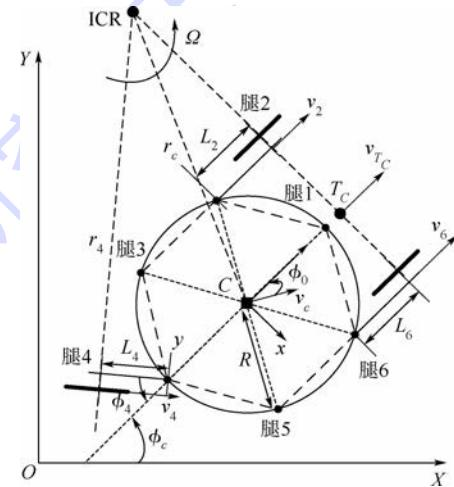
图24 机器人3轮转向机构简图
