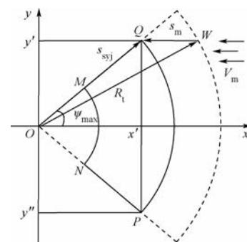
图4 舰空导弹水平杀伤区示意图
