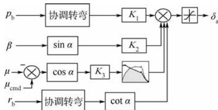
图 10 低动压下的滚转通道控制策略
