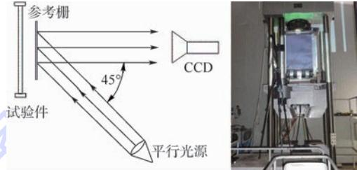
图 3 云纹系统及测试现场
