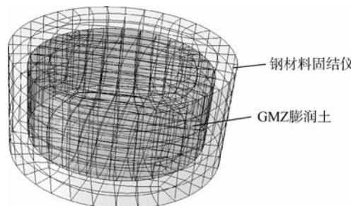
图 10 膨胀力试验的有限元模型及网格
