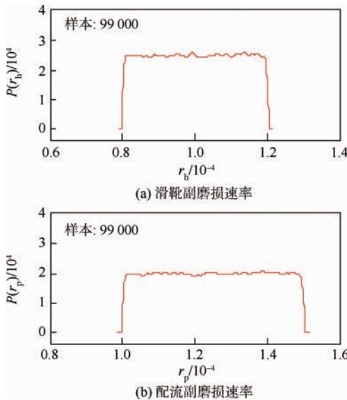
图 11 滑靴副和配流副磨损速率的后验分布
