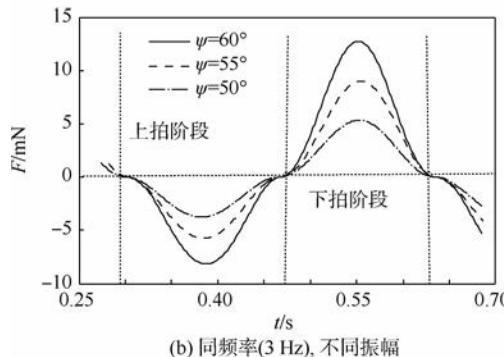
图 6 翅膀拍动频率、振幅与气动力关系
