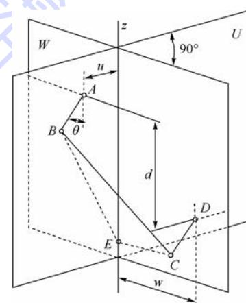
图 7 某民机舱门手柄机构示意图
