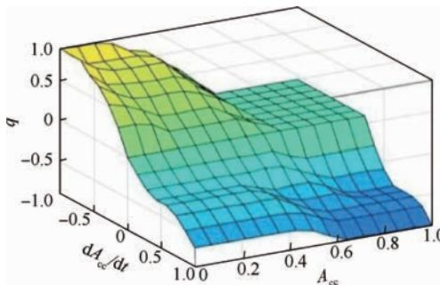
图4 基于加速踏板的制动意图识别结果
