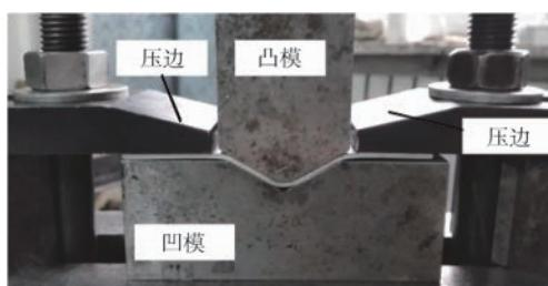
图 6 机械 V 弯实验装置
