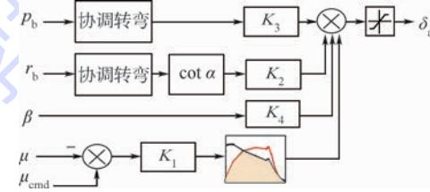
图 12 高动压下的横侧向控制策略
