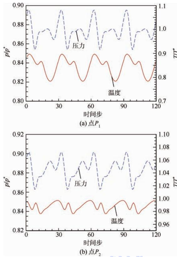
图 7 冷却孔后观察点参数随时间步长的变化
