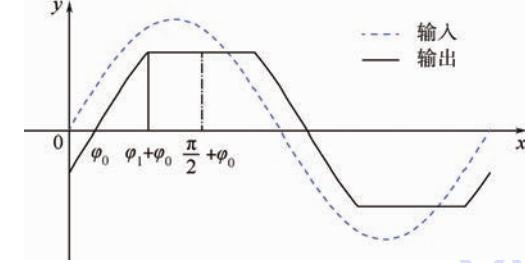
图 4 削峰非线性环节的输入输出波形
