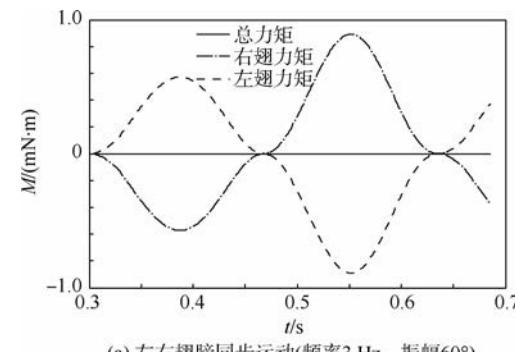
(a) 左右翅膀同步运动(频率3 Hz, 振幅60°)
