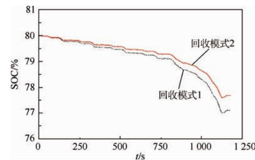
图12 不同能量回收模式下SOC变化曲线
