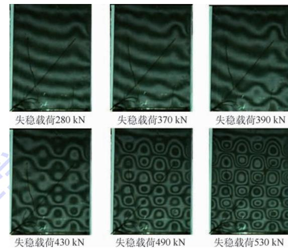
图 10 侧边简支加筋板试验件失稳模态形成过程
