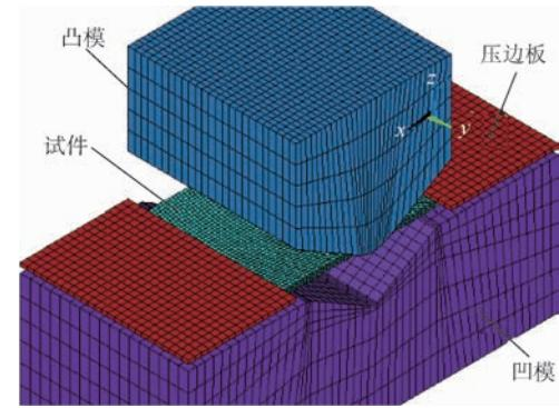
图 10 机械 V 弯数值模型
