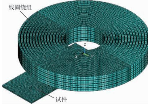
图 8 电磁场中的板料与线圈网格
