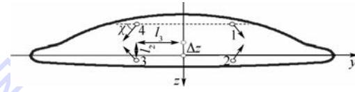
$\chi$ —RCS 喷管与水平方向的安装夹角。
