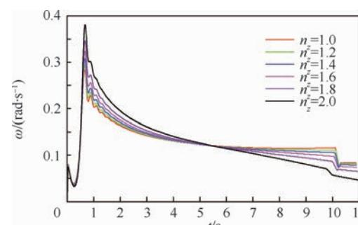
图9 变速设计不同过载工况下支柱绕收放转轴角速度
