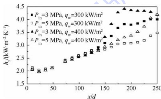
图 7 不同压力下换热系数沿管长分布
