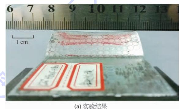
图 12 电磁 V 弯试件横向轮廓
