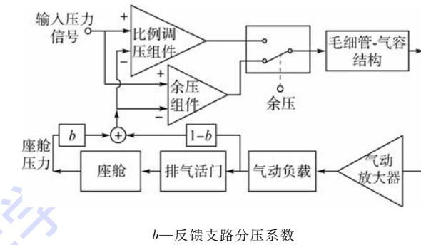
图 1 座舱压力调节系统结构图
