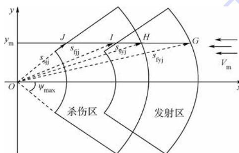
图 5 舰空导弹水平发射区示意图
