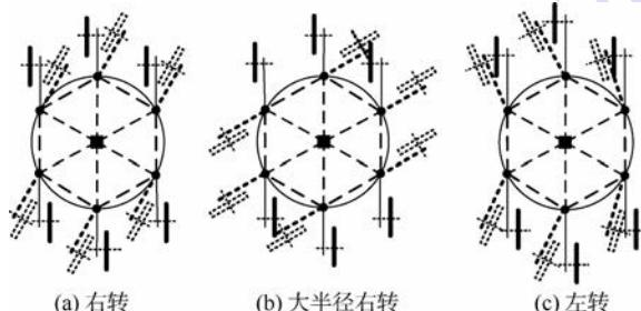
图 20 机器人通过改变腿的布置实现转向的几种情形
