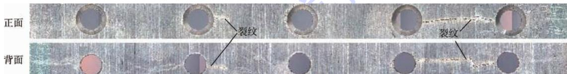
图2 5细节MSD结构孔边裂纹状态
