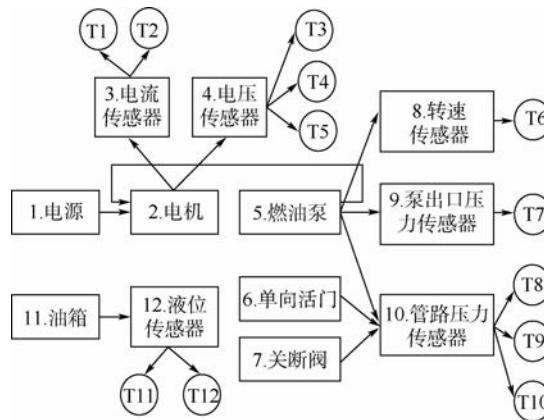
图 5 某型飞机燃油系统多信号流图模型
