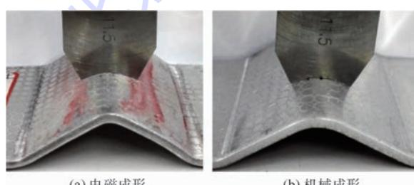
图17 V形圆角外径相同的V弯试件
