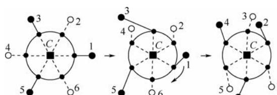
图 13 混合步态切换成Ⅰ型昆虫摆腿步态
