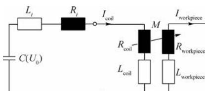
图 2 EMF 过程电路结构<sup>[4]</sup>
