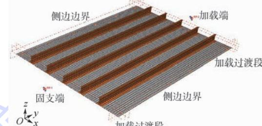
图 7 加筋板有限元模型
