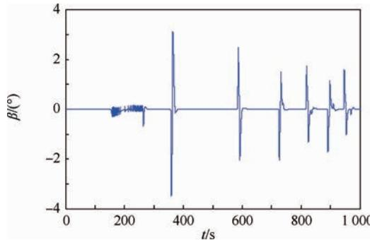
图 14 六自由度模型跟踪标称轨迹:侧滑角响应曲线
