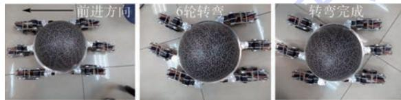
图 30 机器人轮行转弯试验
