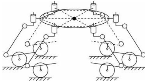
图 19 NOROS 机器人轮行运动模式下机构简图
