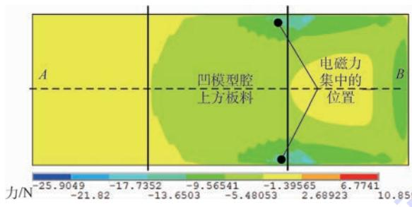
图 14 试件表面的电磁力分布云图
