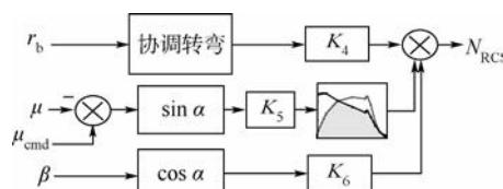
图 11 低动压下的偏航通道控制策略
