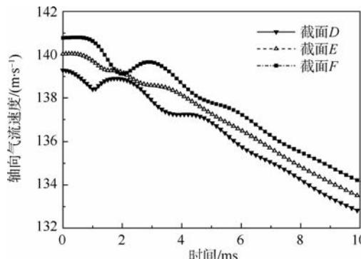
图 10 盘轴间隙气流速度变化过程
