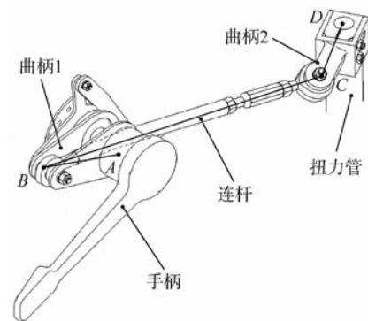
图 6 某民机舱门手柄机构
