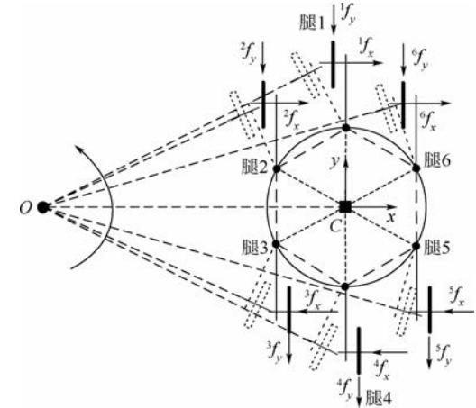
图 21 轮子受摩擦力简图
