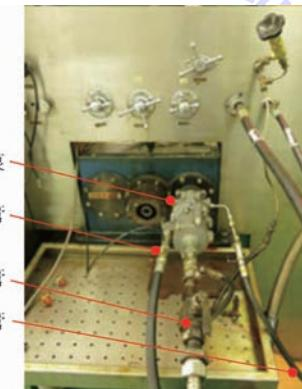
图8 柱塞泵试验平台
