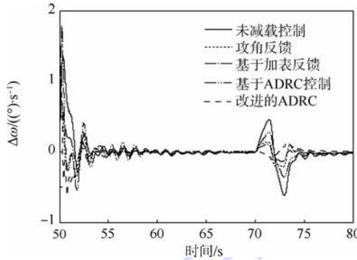
图 9 俯仰角速度偏差随时间的变化
