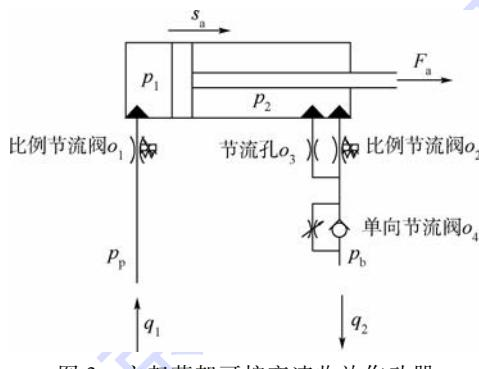
图 3 主起落架可控变速收放作动器
