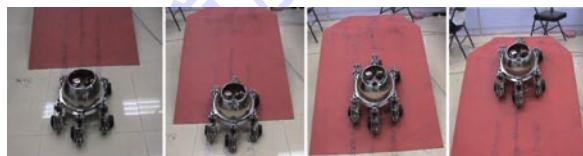
图 31 机器人轮行爬坡试验
