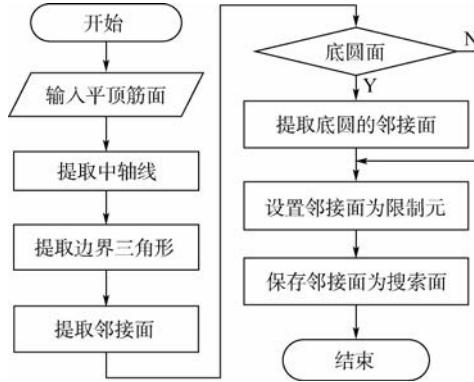
图 12 平顶筋拆分子特征流程
