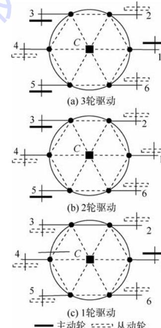
图17 不同数目驱动轮驱动方式
