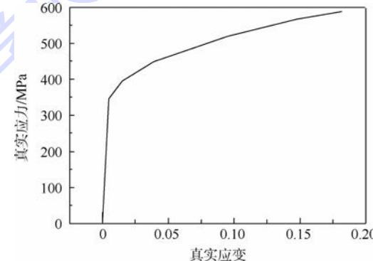
图 3 2024-T3 准静态真实应力-真实应变曲线<sup>[13]</sup>
