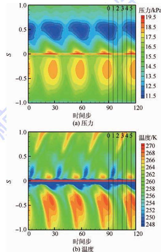
图 9 75% 叶高截面的压力、温度的时空分布
