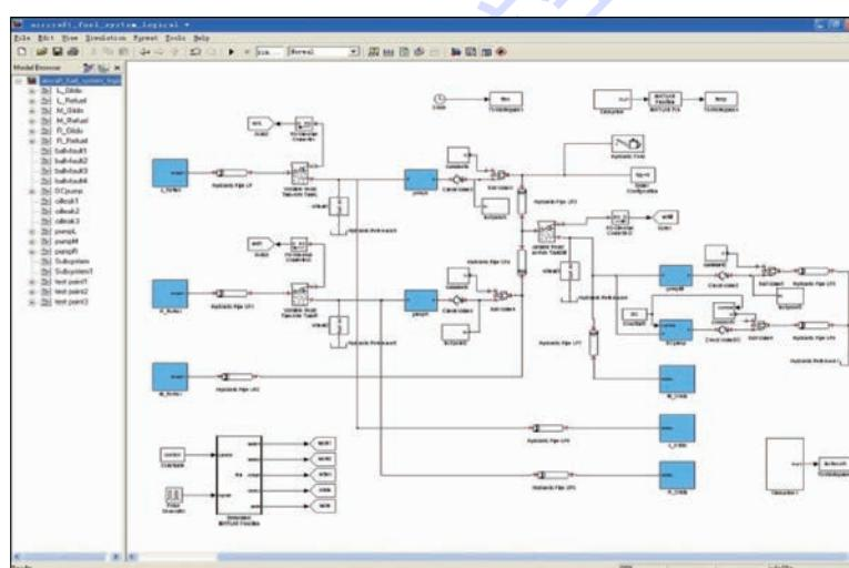
图 4 某型飞机燃油系统 Simulink 仿真模型
