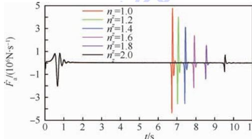
图7 常规设计不同过载工况下作动筒力变化率
