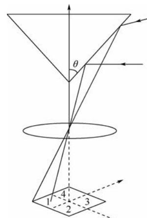
图 4 光学敏感器系统成像模型
