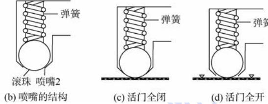
图 3 气动放大器的结构原理与活门 2 的喷嘴结构
