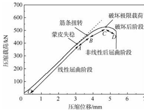
图 8 铝合金加筋板轴压载荷-位移曲线
