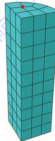
图8 常规三轴试验的有限元分析模型及网格
