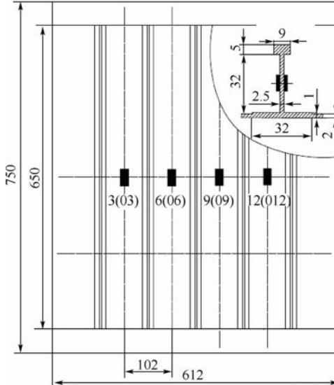
图 1 加筋板试验件示意图
