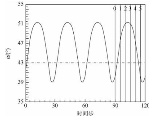
图 11 AGTB 叶栅入射角随时间步长的变化
