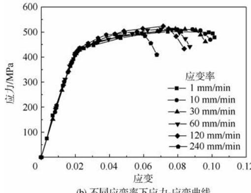
图 5 铝合金材料损伤参数测定试验
