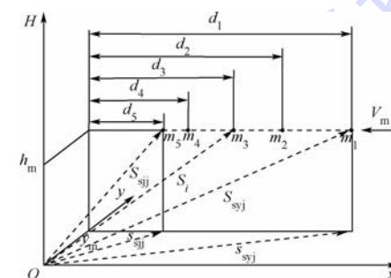
图 6 舰空导弹对敌目标射击过程示意图
