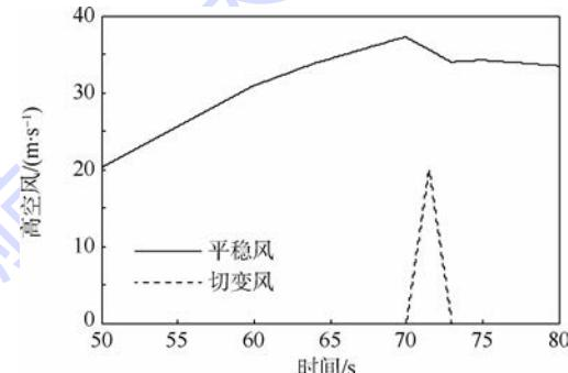
图 4 运载火箭所受到的高空风模型
