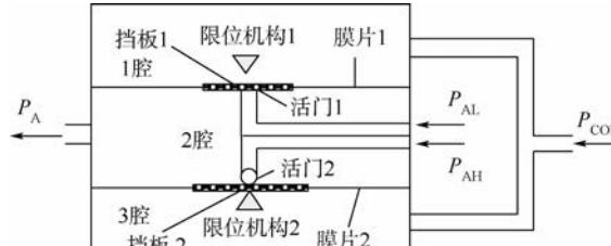
(a) 气动放大器的结构原理及外部联结
