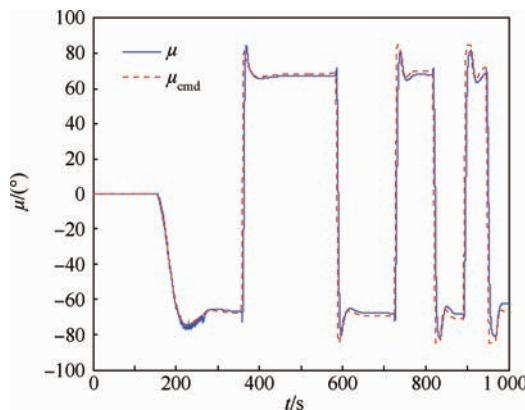
图 15 六自由度模型跟踪标称轨迹:滚转角响应曲线
