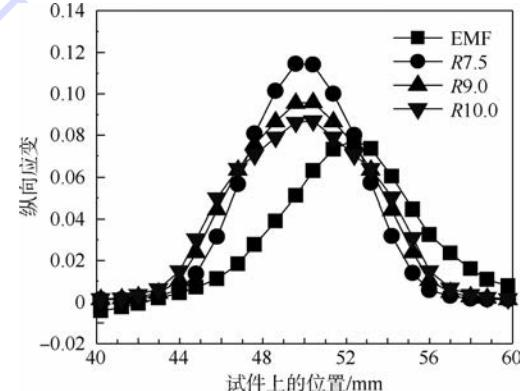
图 15 试件 V 形圆角外侧纵向拉应变
