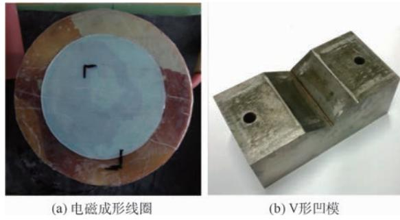
图 4 电磁成形线圈和 V 形凹模
