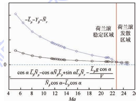
图 6 荷兰滚阻尼预测式分解
