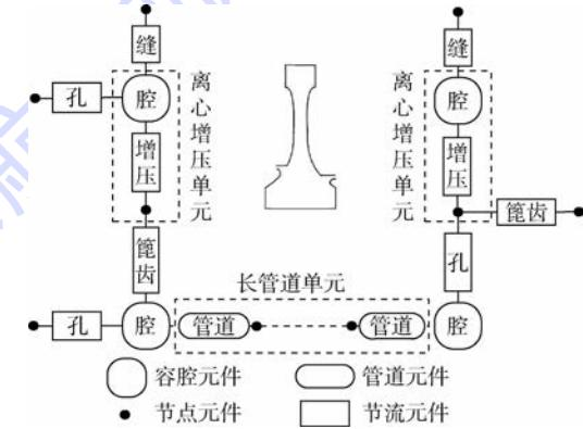
图 9 涡轮盘局部空气系统模型
