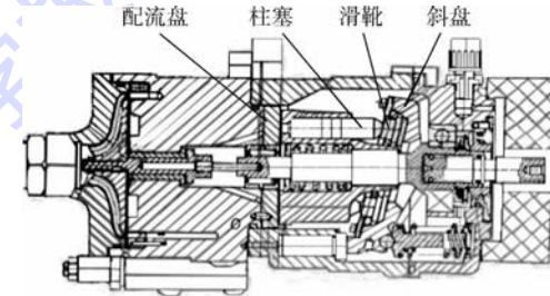
图3 某型轴向柱塞泵结构
