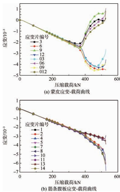
图 9 铝合金加筋板典型应变结果
