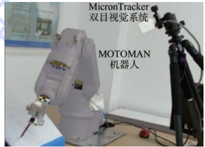
图5 机器人执行示教程序
