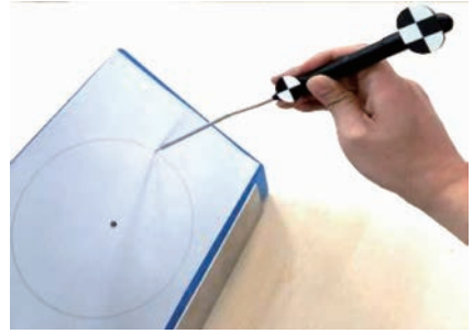
图4 利用示教工具进行示教
