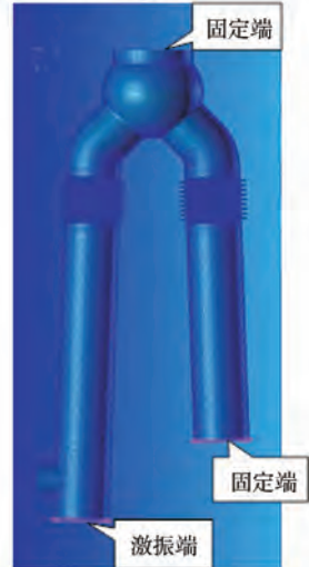
(b) 输送管有限元模型
