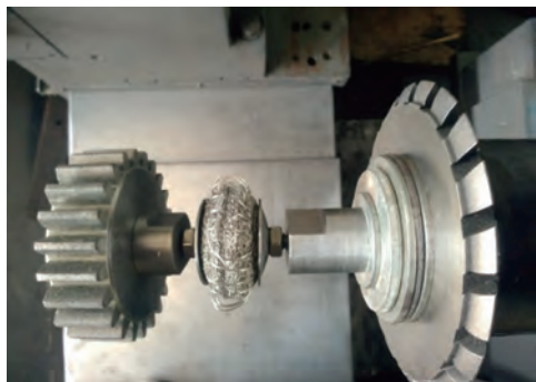
图9 面齿轮磨珩复合磨削刀具结构
