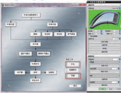
图 13 涡轮叶片快速建模系统与导管建模程序
