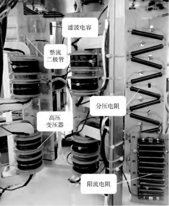
图 8 油箱内后级高压电路实物
