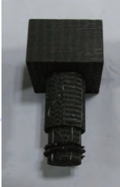
图2 缎纹编织碳/碳复合材料紧固件
