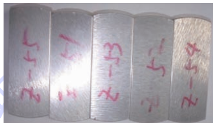
图 1 不同 SiCp 增强颗粒含量的 SiCp/Al 复合材料试样 Fig. 1 SiCp/Al composite specimens with different contents of SiCp reinforced particle
