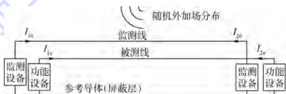
图1 线缆耦合干扰实时监测方法原理
