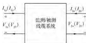
图2 监测/被测线缆系统二端口网络模型
