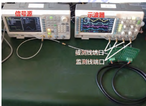
图 12 验证系统实物图 Fig. 12 Photo of validation system
