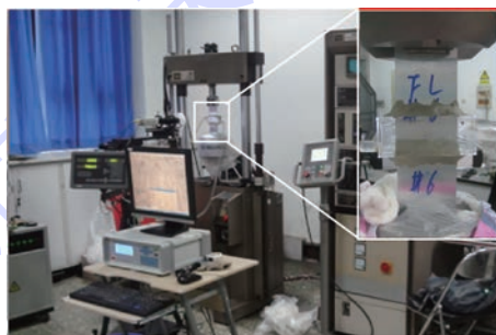
(a) 裂纹扩展试验系统
