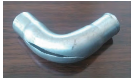
图 14 过度弯曲的管材自由胀形过程实验样件
