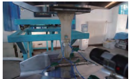
图 8 疲劳裂纹监测试验现场
