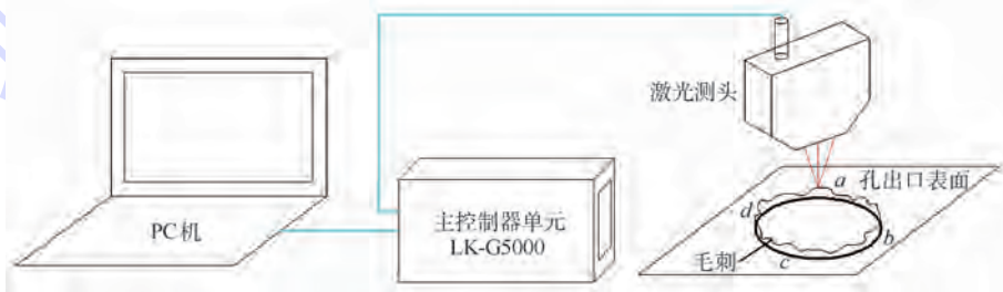
图5 孔出口毛刺高度的非接触激光测微仪系统测量
