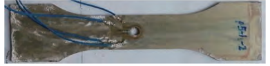
图 7 盐雾腐蚀试验后试件形貌
