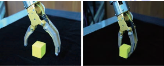
图 5 末端执行器的结构 Fig. 5 Structure of end effector
