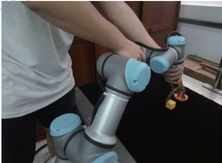
图 6 人工拖动示教编程 Fig. 6 Manual drag teaching programming
