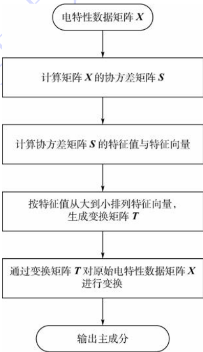
图 2 PCA 方法流程 Fig. 2 Flowchart of PCA method
