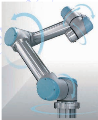
图 3 UR3 机器人及其关节轴
