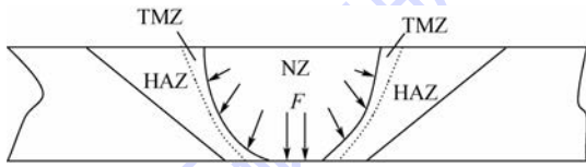
图 11 超声能对焊缝整体流变区域的影响示意图
