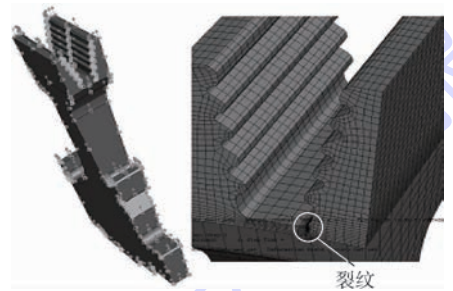
图3 航空发动机涡轮盘模型裂纹示意图
