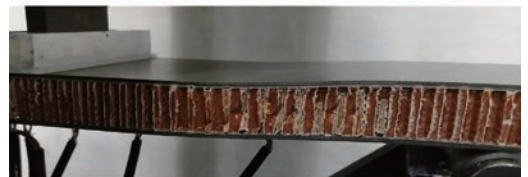
(b) 修理件破坏模式细节图
