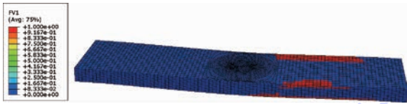
图15 修理件破坏位置
