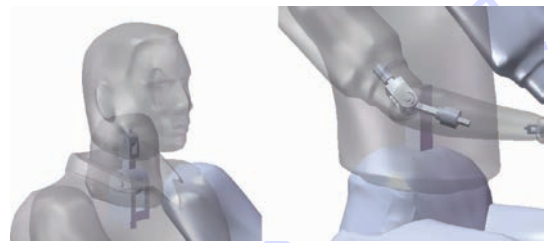
图4 机械关节与假人模型的连接
