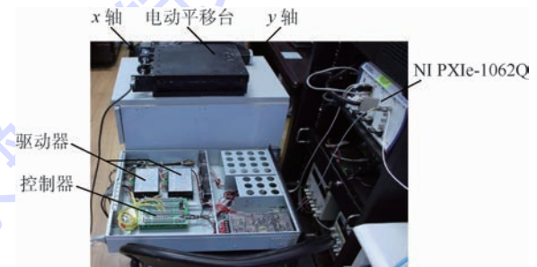
图 3 电动平移台及其控制器
