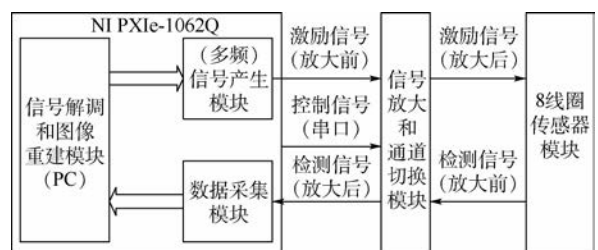
图 4 8 线圈传感器激励检测系统
