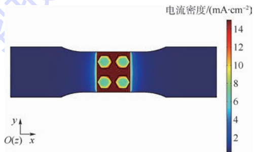
图8 搭接件表面的电流密度分布
