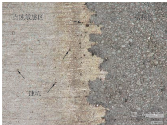
(a) 过渡位置的腐蚀形貌
