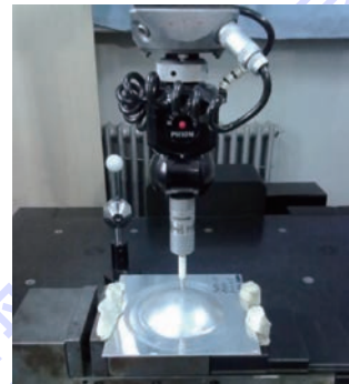
图 7 三坐标测量仪测量示意图
