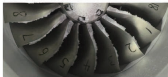
(c) 转速为 3000 \text{ r/min} 时冰脱落结果
