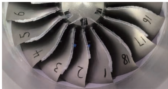
(a) 环境温度为 -2^{\circ}\text{C} 时冰脱落结果
