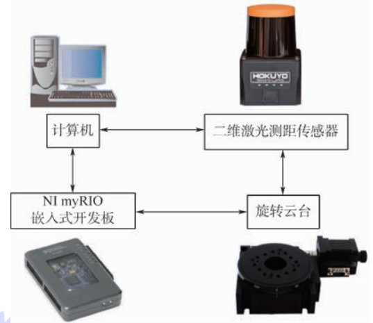
图7 三维激光扫描系统构成示意图
