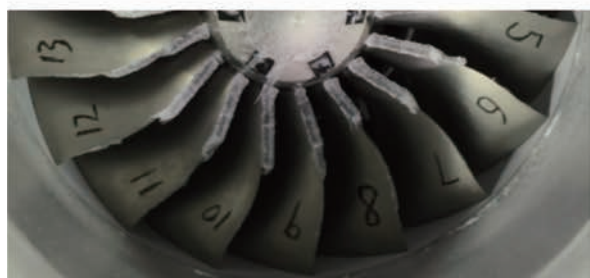
(c) 环境温度为 -5^{\circ}\text{C} 时冰脱落结果
