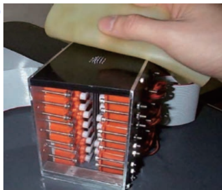
图4 触觉显示样机 [18] Fig.4 Tactile display prototype [18]
