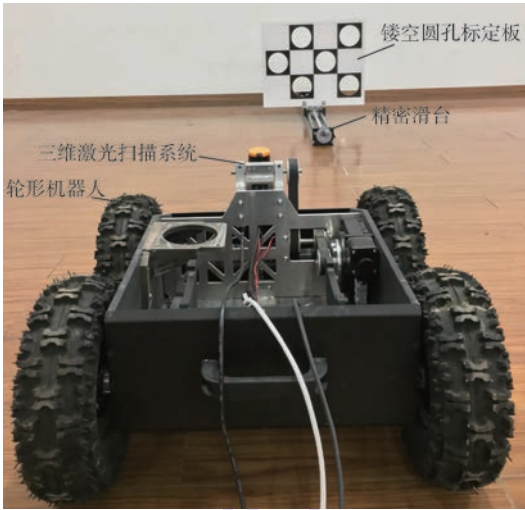
图 9 三维激光扫描系统标定现场
