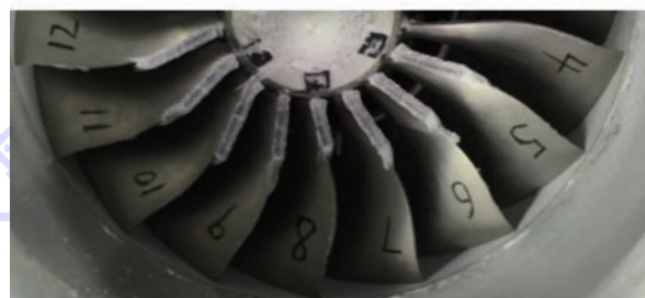
(b) 转速为 2700 \text{ r/min} 时冰脱落结果
