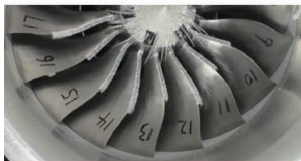
(b) 环境温度为 -3.5^{\circ}\text{C} 时冰脱落结果
