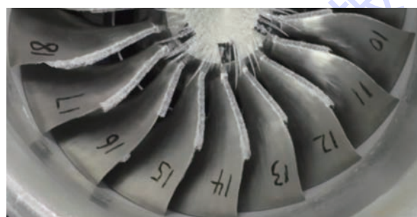
(a) 转速为 2400 \text{ r/min} 时冰脱落结果
