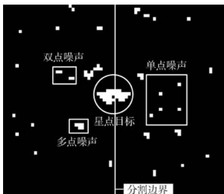
图3 局部星图的阈值化结果
