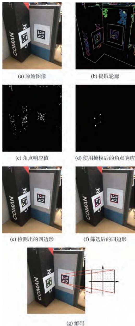
图2 二维编码点的检测和识别
