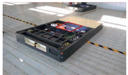
图 8 搭载视觉定位系统的 AGV
