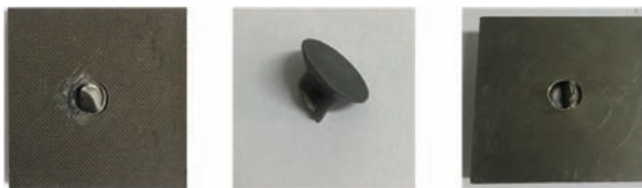
图4 SLR1 试验件破坏示意图
