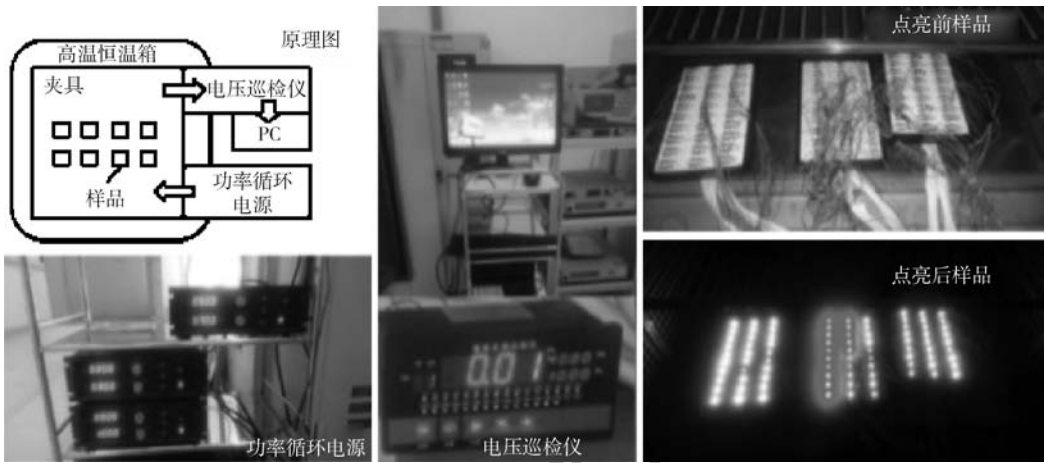
图3 LED功率循环老化试验平台装置图
