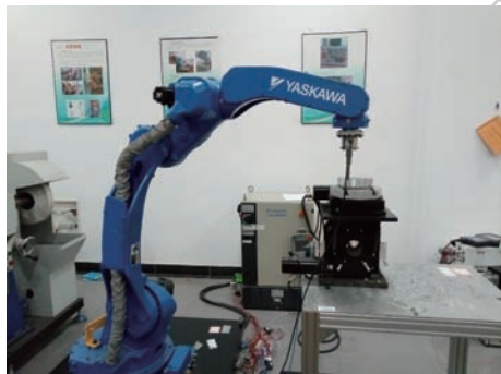
图5 机器人曲面恒力跟踪实验平台
