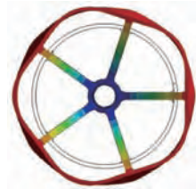
图 8 轮体旋转状态变形放大示意图
