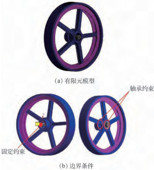
图 18 动量轮结构系统仿真计算模型 Fig. 18 Simulation calculation model of momentum wheel structural system
