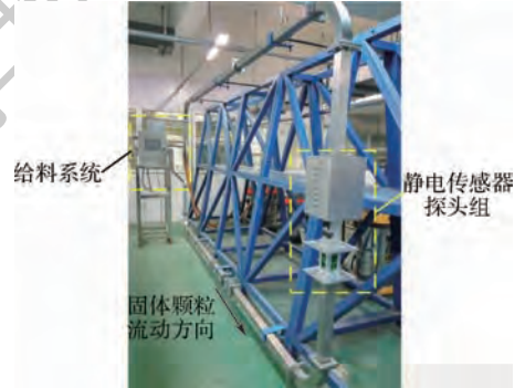
图 4 方形截面管道气力输送实验装置
