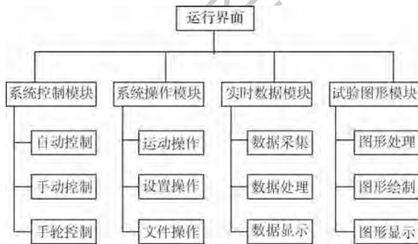
图3 10 kN 超声辅助塑性成形压力机控制软件框架
