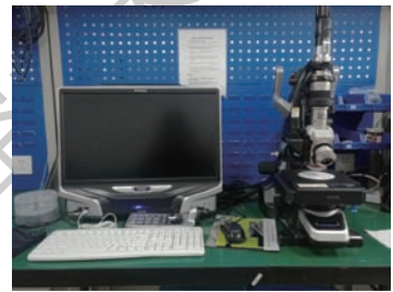
图 17 VHX-6000 超景深显微镜
