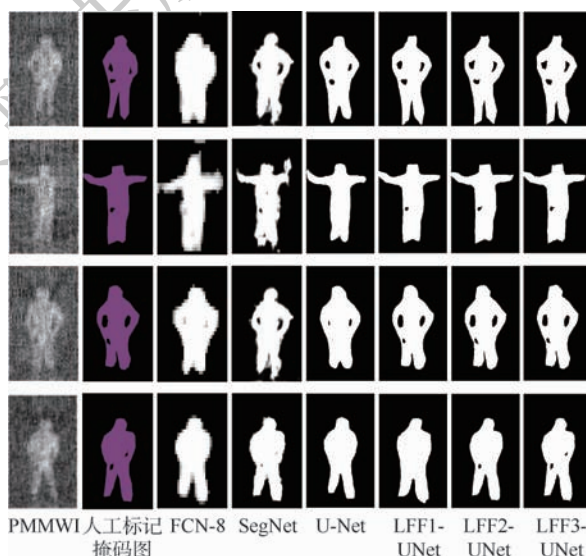
图 13 不同 DNN 模型 PMMWI 人体轮廓分割对比 Fig. 13 Comparison of human contour segmentation in PMMWI among different DNN models
