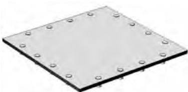
图 2 嵌入式电极的 CFRP 层合板模型
