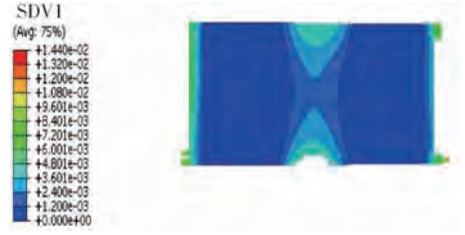
图 11 FJF 胶接连接接头胶层即将失效时等效塑性应变
