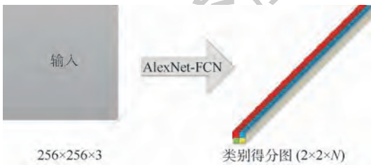
图 1 FCN 滑动窗口形式 Fig. 1 FCN sliding window
