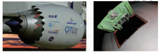
(a) 波音777泄压门 (b) 典型泄压门结构
