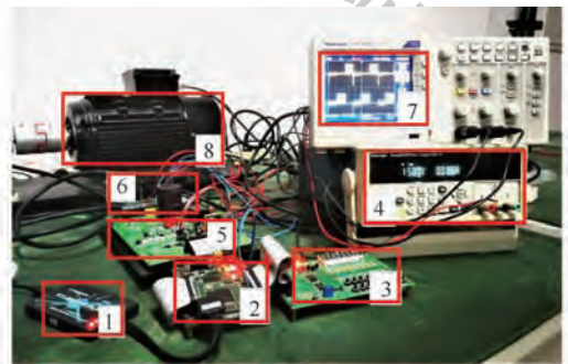
1—仿真器;2—DSP控制板;3—显示按键板;4—DC电源;5—驱动板;6—霍尔电流传感器;7—TDS2012C示波器;8—SRM。
