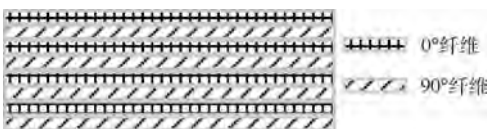
图 1 正交型 CFRP 层合板模型
