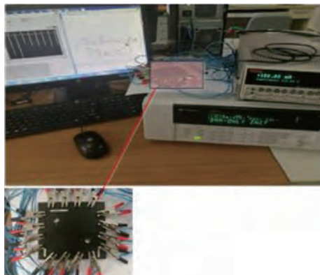
图 6 搭建的 EIT 硬件系统和测试材料
