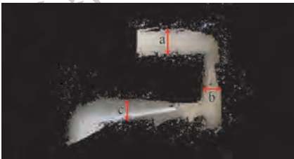
图 12 办公室通路宽度测量
