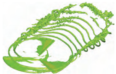
图14 低速飞行状态笛卡儿自动背景网格自适应计算旋翼涡量等轴视图
