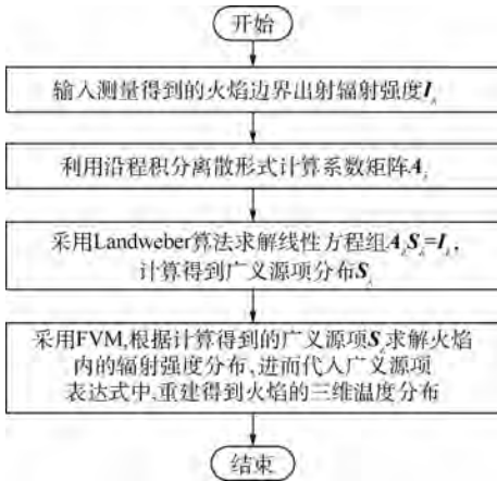
图 2 基于光场成像与 Landweber 算法的火焰温度场重建流程
