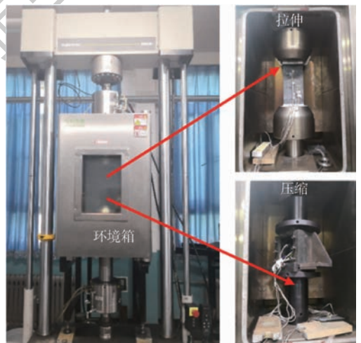
图 3 带有环境箱的拉伸和压缩试验装置
