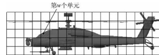
图 5 武装直升机网格划分示意图(侧向遭受打击时)
