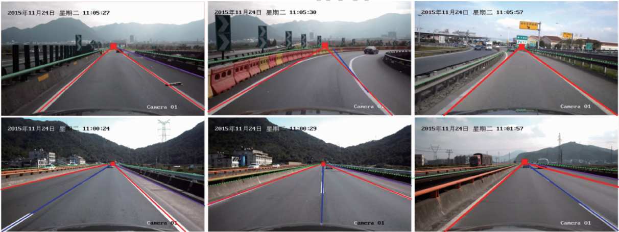
图7 高速道路的车道检测结果
