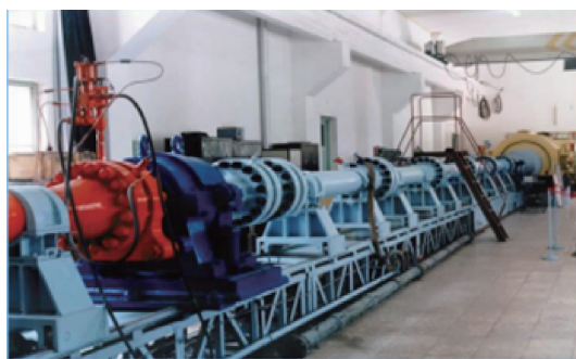
图 1 JF8A 高超声速激波风洞
