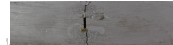
图 4 含单侧面板裂纹损伤钛合金蜂窝夹层结构三点弯曲试验典型破坏模式
