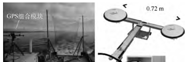
图7 T型GPS天线 [14]
