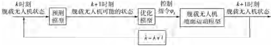
图3 轨迹控制方法结构示意图
