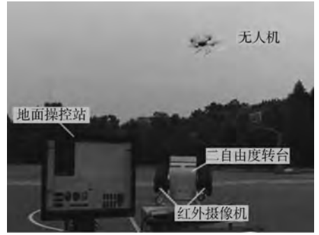
图 9 短基线地基双目引导系统 [16]
