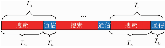
图9 星型网络通信流程
