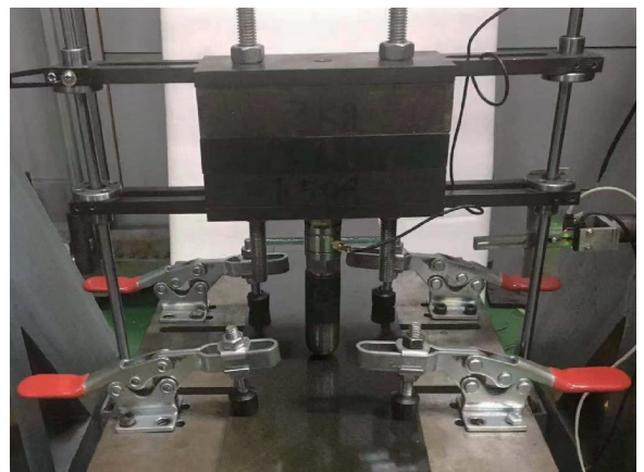
图2 冲击试件夹持
