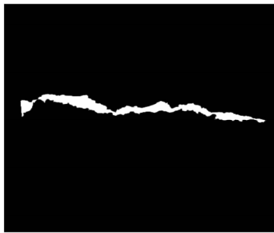
(b) 未熔合缺陷图像处理后效果图
