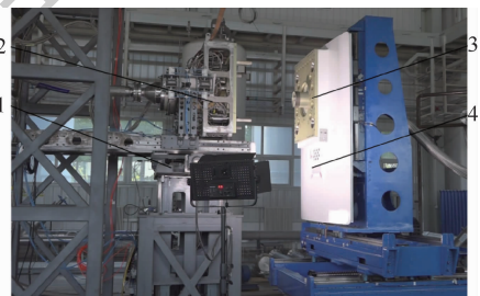
1—自动对接装置;2—组合连接器;3—箭上接口;4—箭体模拟运动台。
