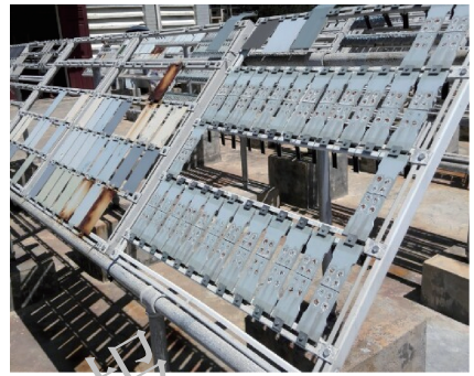
图 4 自然曝晒试验架
