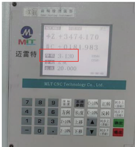
图 7 蜗杆齿距测量(齿距为 3.13 mm)
