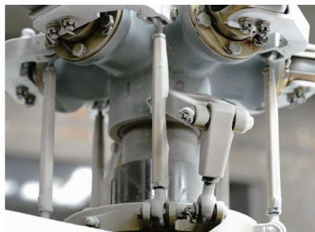
图4 桨毂及变距机构上的结冰情况
