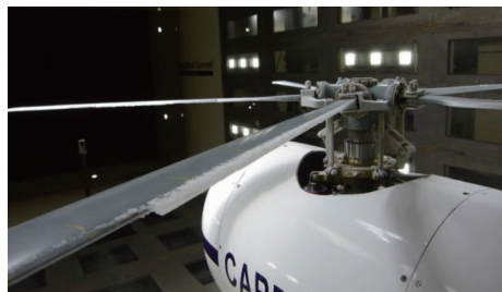
图3 桨叶上的结冰情况
