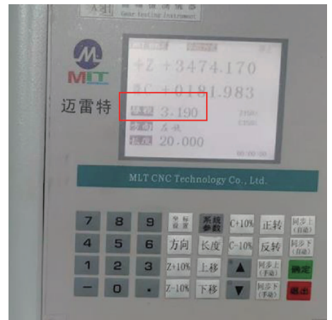
图6 蜗杆齿距测量(齿距为3.19 mm)
