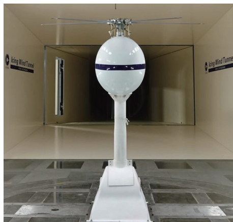
图1 安装在CARDC结冰风洞中的旋翼试验台
