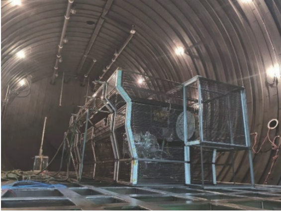
图7 初样星真空热试验
