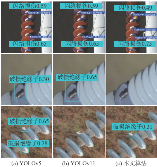
图 3 不同检测算法的缺陷识别效果示例 Fig. 3 Example diagram of defect recognition effect of different detection algorithms
